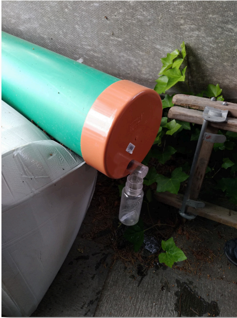
Рис.3.8. Зовнішній вигляд виводкової камери для комах, що розвиваються у ксилотрофних грибах.
