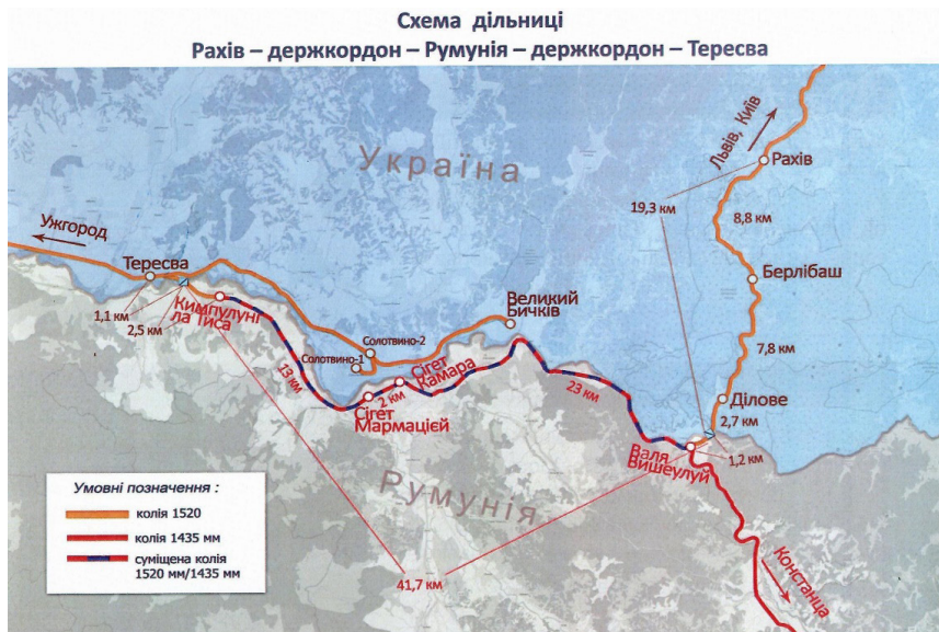
Рисунок 2. Схема відновлення маршрутів руху потягів на дистанції Рахів–Сігету-Мармацієй–Тересва
