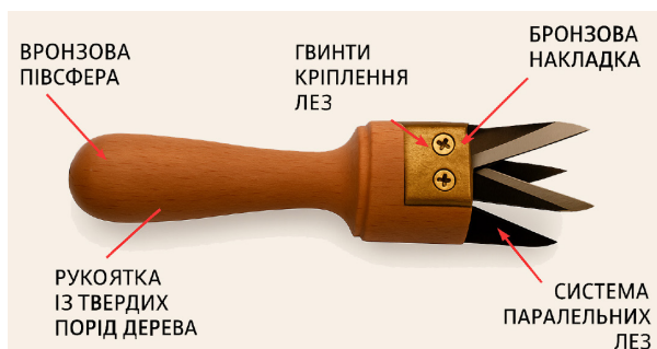
Мал. 54. Ніж італійської фірми DUE BUOI 2261 для окулювання винограду трубкою
