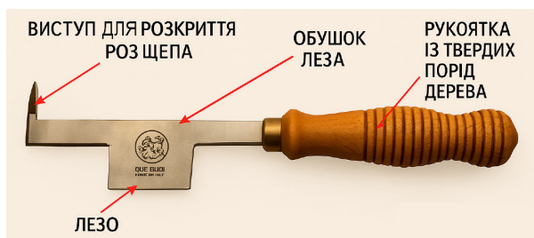
Мал. 55. Долото італійської фірми DUE BUOI для щеплення у розщип
